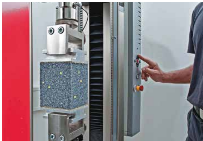
Test de traction perpendiculaire sur banc d'essai. Il permet de vérifier la parfaite cohésion du bloc, qui conditionne à la fois sa stabilité et sa durabilité.
