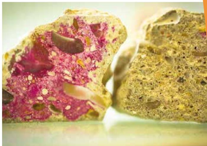
granulats issus de la démolition. L'injection dans ces granulats plus poreux, enrobés d'un peu de ciment, provoque une carbonatation qui a l'avantage d'améliorer leurs propriétés. Mais le processus ne réduit pas les émissions de CO<sub>2</sub>, il les absorbe à travers un procédé industriel qui consiste à carbonater des granulats recyclés. Il réduit simplement l'empreinte carbone, le CO<sub>2</sub> n'étant pas émis dans l'atmosphère mais "stocké" dans les granulats.
