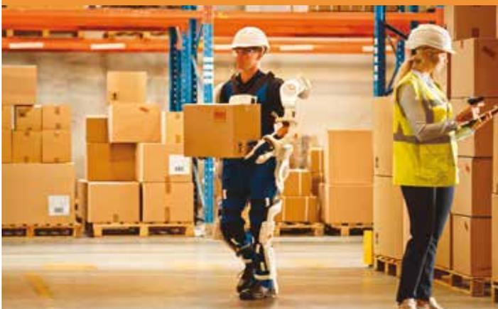
**En robotique, un exosquelette est un équipement articulé et motorisé, fixé sur le corps au niveau des jambes, du bassin, des épaules et/ou des bras. Il facilite les mouvements grâce à la force de ses petits moteurs électriques.** Comme un vélo à assistance électrique, il soulage et accompagne le geste. Ce sont les forces armées qui ont été les premières à s'y intéresser pour que les militaires puissent marcher longtemps malgré leurs pesants équipements, l'objectif étant de réduire la fatigue.
