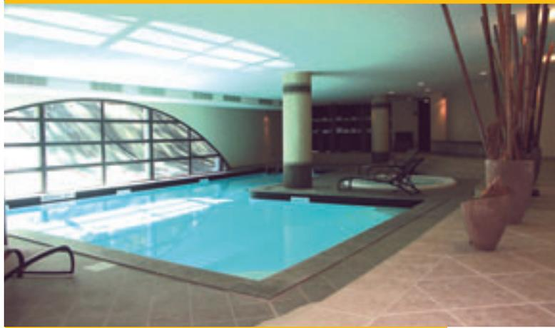
■ **En béton armé coulé**, le bassin est réalisé avec des banches qui forment une paroi de 20 à 25 cm d'épaisseur. Le béton, rendu étanche par l'ajout d'hydrofuges ou de résines époxy, est coulé puis vibré soigneusement pour chasser les bulles d'air et augmenter son étanchéité. Cette structure est idéale pour la pose de carrelage en céramique ou en pâte de verre.
