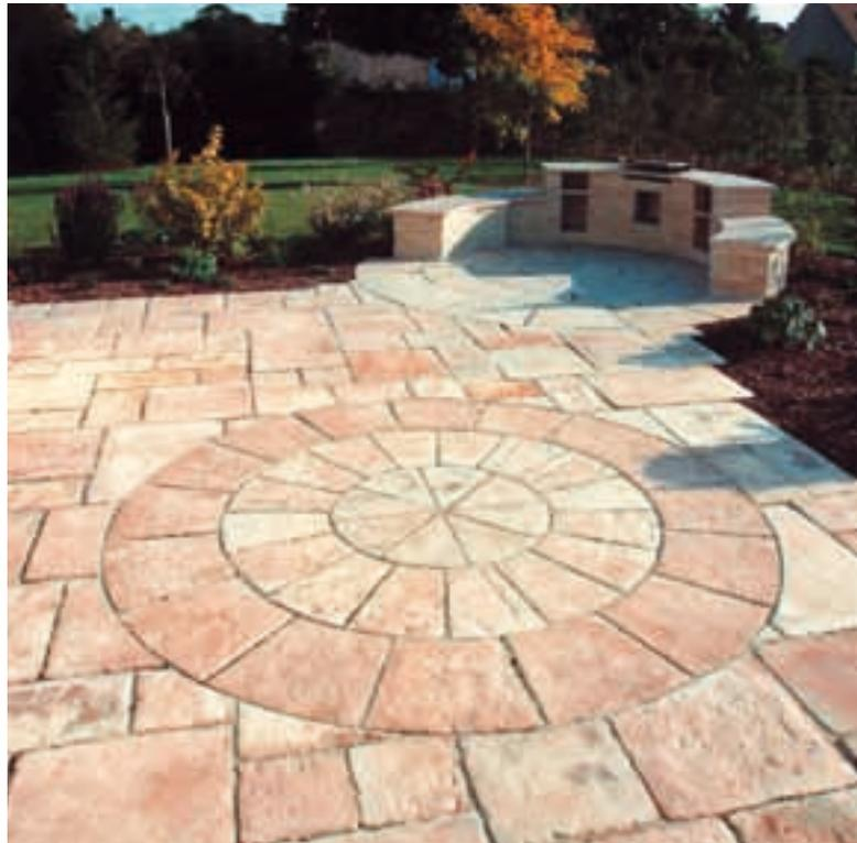
et constitue une chape plus ou moins continue. La mise à niveau est ainsi réalisée en fonction de l'irrégularité des dalles. Pas de mortier à enlever ou à rajouter. Le remplissage des joints est réalisé avec du sable fin et sec (voir la pose sur sable). Pour éviter que le sable ne soit en partie emporté par les eaux de pluie et/ou obtenir une finition classique avec joints de mortier, il est possible d'appliquer une couche mince de produit de jointoyage.
