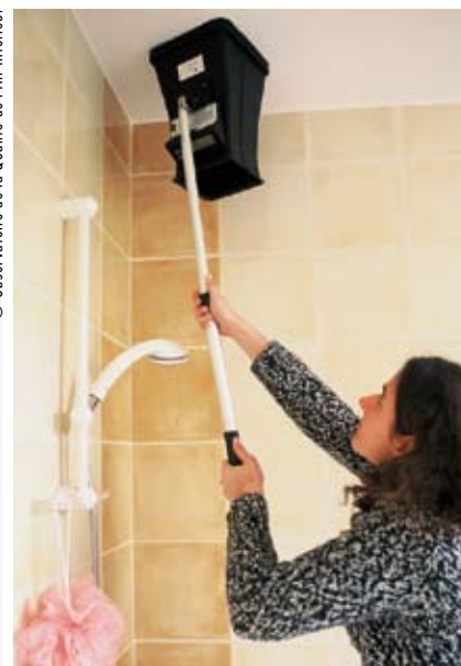
Mesure du débit d'air extrait aux bouches d'extraction
