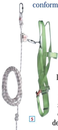
• **Un harnais** se compose d'un certain nombre de sangles convenablement disposées et réglables pour répartir sur l'ensemble du corps les efforts développés lors de la chute. Pour permettre la fixation du système de liaison, un harnais comporte un ou plusieurs points d'accrochage qui peuvent être sternaux (situés au milieu de la poitrine ou déportés) ou dorsaux. Une combinaison des deux systèmes est souhaitable.
