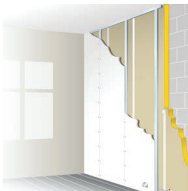
Un exemple d'isolation par l'intérieur avec une ossature métallique et des panneaux semi-rigides avec façade papier kraft en laine de verre.
