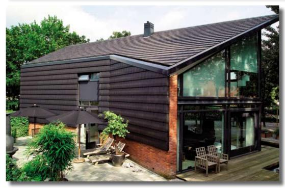
Les vêtures sont des complexes associant un isolant en mousse synthétique (PSE, PUR, PSEX) ou en laine de roche et un parement extérieur de protection.
