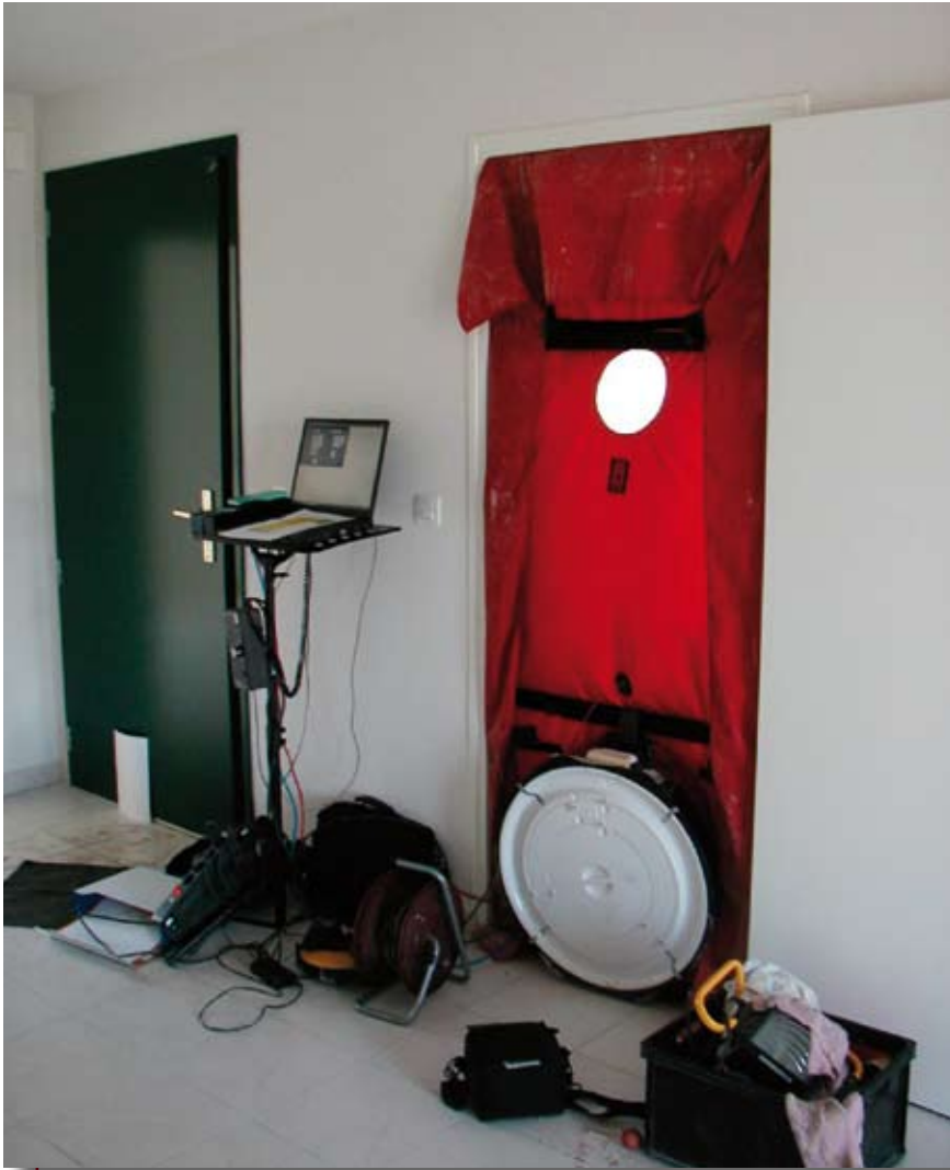
Le test de la Blower Door permet de quantifier l'étanchéité à l'air du bâtiment.
