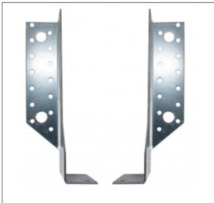
Les sabots deux éléments SDE permettent de s'adapter à des sections de bois dont la largeur est comprise entre 60 et 160 mm. La mise en oeuvre des pointes dans la base du sabot est impérative pour assurer un bon assemblage.
