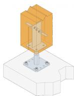
Les pieds de poteau type PPS permettent la réalisation d'assemblages discrets et fiables. Leur conception en âme assure une reprise de charges au soulèvement.
