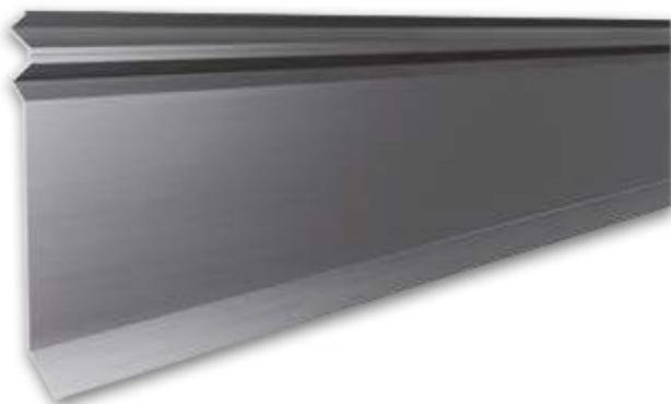
Bande d'étanchéité rigide en aluminium extrudé pour l'étanchéité lors des travaux de couverture. Raccordement et protection, en couverture sur combles, de relevés d'étanchéité au droit de pénétrations continues (intersection de pan de toiture avec mur de maçonnerie) ou discontinues (souche de cheminée, jouée de lucarne, etc). Raccordement et protection de relevés d'étanchéité au droit d'émergences, pénétrations, reliefs (acrotères, souches de conduits, ventilation, fumée).
