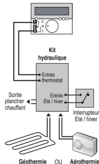
Pompe à chaleur avec entrée thermostat chaud et entrée thermostat froid
