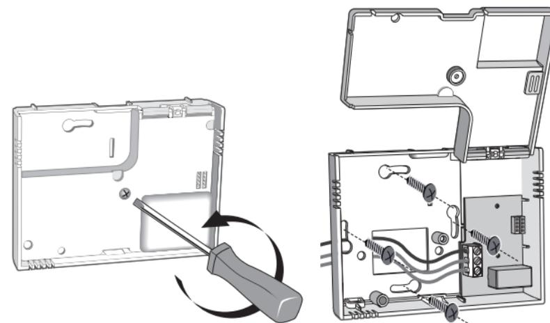
Des cloisons (repère **3**) défonçables avec une pince sont prévues pour laisser passer les câbles de raccordement si nécessaire.
