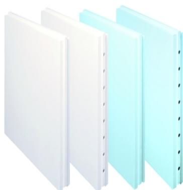
Carreau de plâtre hydrofugé (reprise en eau après 2 heures d'immersion inférieure à 5%), à parements lisses et verts, qui permet d'assurer, sans mise en œuvre particulière, la pérennité des cloisons de tout local privatif ou assimilé exposé à l'humidité
