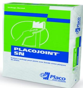
Enduit poudre à séchage permettant le traitement manuel ou mécanique des joints avec bande papier. Le redoublement des joints se fait après durcissement complet de l'enduit et dépend essentiellement des conditions climatiques (12 à 48 heures).
