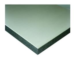
Complexe de doublage constitué d'un panneau isolant en polystyrène expansé (PSE) graphité et élastifié, associé à une plaque de plâtre Placo®. Parement muni d'un film pare-vapeur, à haute résistance à la diffusion de la vapeur d'eau.
