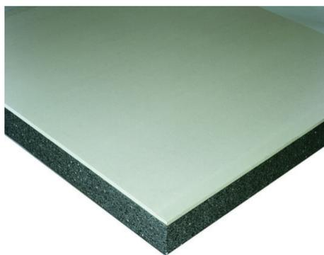
Complexe de doublage constitué d'un panneau isolant en polystyrène expansé (PSE) graphité et élastifié, associé à une plaque de plâtre Placo®. Parement muni d'un film pare-vapeur, à haute résistance à la diffusion de la vapeur d'eau.
