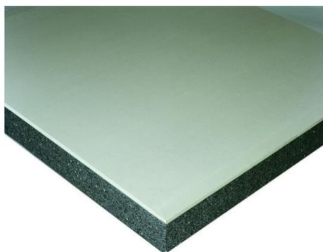
Complexe de doublage constitué d'un panneau isolant en polystyrène expansé (PSE) graphité et élastifié, associé à une plaque de plâtre Placo®. Ancien libellé: Doublissimo® 30 13+80.
