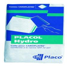
Colle à carreaux de plâtre hydrofugés. Durée d'utilisation : 1 heure 30\_x000D\_. Consommation : 1,1 à 2,5 kg / m² (selon l'épaisseur des carreaux). Conditionnement en sac de 25 kg.
