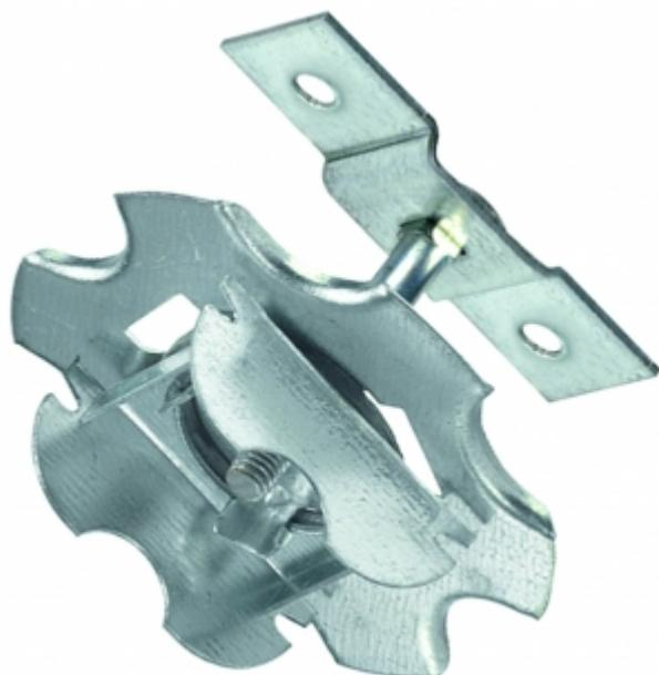
Système de fixation composé d'une platine en omega à visser, d'une vis à embase carrée et d'une rosace Rosastyle. Elle est réglable jusqu'à 25 mm.
