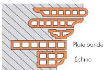
**Pose des moulures :** après trempage des produits, les éléments sont posés à bain soufflant de mortier sur les assises parfaitement planes.
