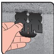
1. Insérer la suspente hourdis entre deux hourdis béton.
