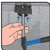
2. Enfoncer la suspente hourdis à l'aide d'un marteau
