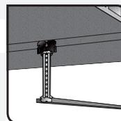
4. Vous pouvez également visser une suspente courte ou longue Semin (avec vis TRPF) sur la suspente hourdis et fixer la fourrure sur la suspente courte ou longue
