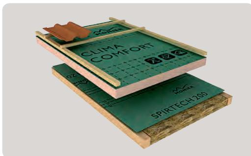
Si l'étanchéité à l'air ne peut être réalisée en sous-face de l'isolant complémentaire, elle sera réalisée en utilisant une membrane respirante entre cet isolant complémentaire et le panneau CLIMA COMFORT® (écran respirant avec une valeur  $S_d \leq 0,1$  m de type Ecotech® 200 ou Spirtech® 200).
