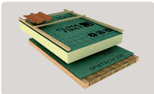
Si l'étanchéité à l'air ne peut être réalisée en sous-face de l'isolant complémentaire, elle sera réalisée en utilisant une membrane respirante entre cet isolant complémentaire et le panneau CLIMA FIRST® ou CLIMA FIRST® PLUS (Écran respirant avec une valeur  $S_d \leq 0,1$  m de type Ecotech® 200 ou Spirtech® 200). Dans cette configuration également, l'épaisseur du panneau doit obligatoirement être supérieure à l'épaisseur de l'isolant complémentaire afin d'éviter tout risque de condensation.
