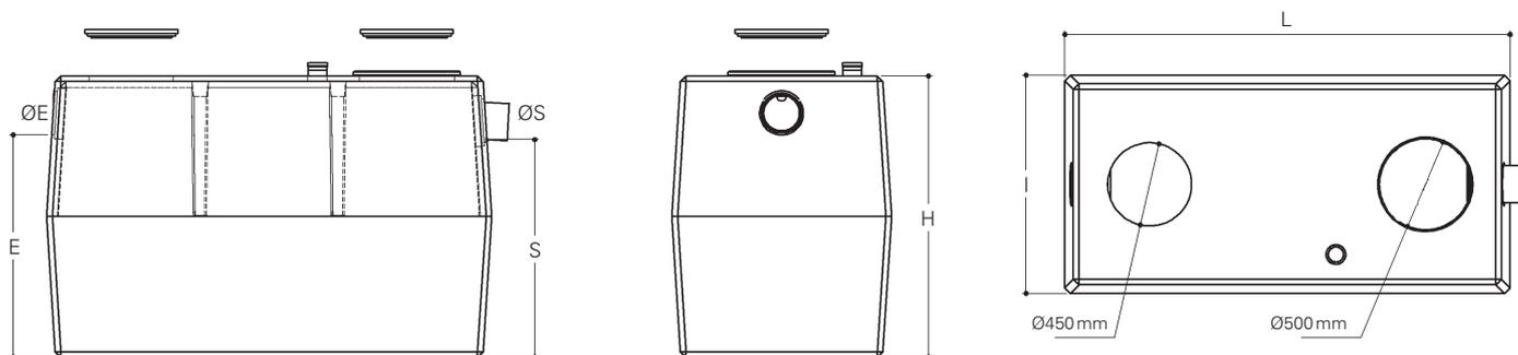
L'installation des appareils doit respecter les règles de l'art et les consignes de notre notice de pose fournie avec chaque appareil également disponible sur demande ou sur notre site internet [www.sebico.com](http://www.sebico.com). Séparateurs de catégorie 1D : installation hors passage de véhicules et absence de nappe phréatique. Remblai sur la cuve de 50 cm maximum.
