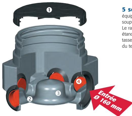
**5 sorties** Ø 100 mm équipées d'un joint souple à lèvres. Le raccordement est étanche et accepte les tassements naturels du terrain.
