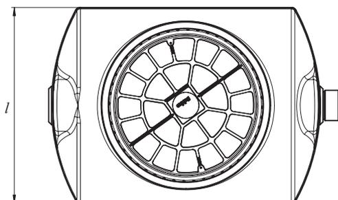
L'épandage a pour fonction de recevoir les eaux prétraitées issues de la fosse septique ou du décanteur digesteur et de permettre leur répartition, leur infiltration et leur épuration dans le sol. L'installation de la chasse automatique en tête d'épandage améliore l'efficacité et augmente sa longévité.
