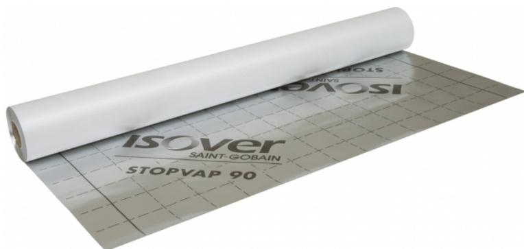
Film pare-vapeur aluminisé, armé d'un voile non tissé, dont la résistance à la diffusion de la vapeur d'eau (Sd) est supérieure à 90 m. Elle est quadrillée pour faciliter la découpe et la mise en oeuvre.
