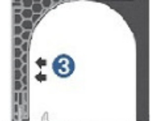
3 Renfort d'inertie : équerre tous les 300 mm
