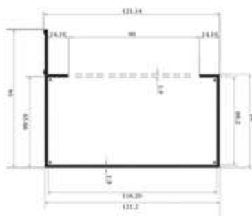
Principe de pose chéneau Xtra
