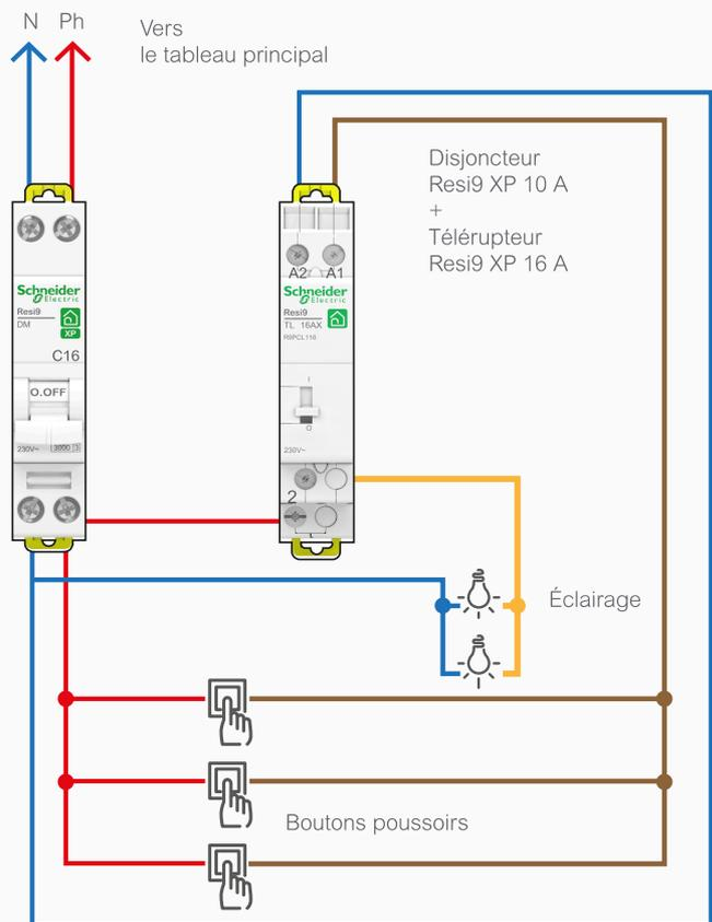
Section des conducteurs cuivre de 1,5 mm<sup>2</sup>
