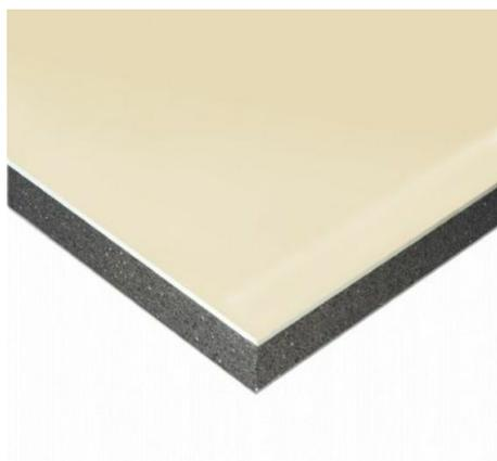
Complexe de doublage constitué d'un panneau isolant en polystyrène expansé (PSE) graphité, associé à une plaque de plâtre Placo®. Parement plaque Placomarine® BA13, à haute résistance à l'humidité.
