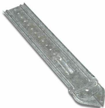
Accessoire de suspension de plafonds en plaques de plâtre en fourrures Placostil® sous rampant. Permet d'assurer rapidement et sans accessoire supplémentaire, le maintien des isolants fibreux avant la pose et le clipsage des fourrures Stil® F 530
