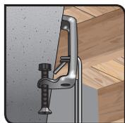
Après avoir défini la longueur en fonction de la hauteur de votre plénum, insérer l'extrémité de la tige en forme de crochet dans le support.
