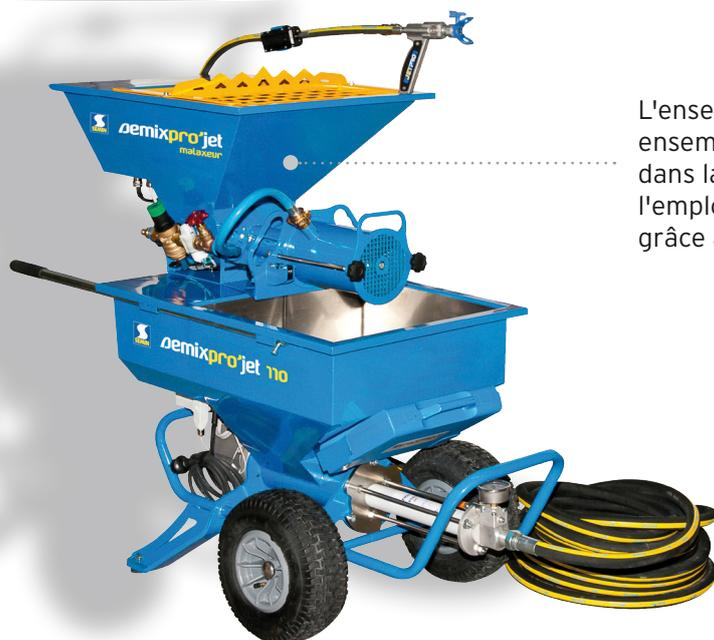
L'ensemble **semix'pro jet 110** est un ensemble **haut rendement** spécialisé dans la pulvérisation des enduits prêts à l'emploi ainsi que des enduits en poudre grâce à **semix'pro malaxeur**.
