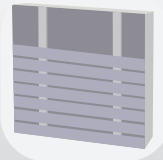
Pose horizontale simple lambourrage
