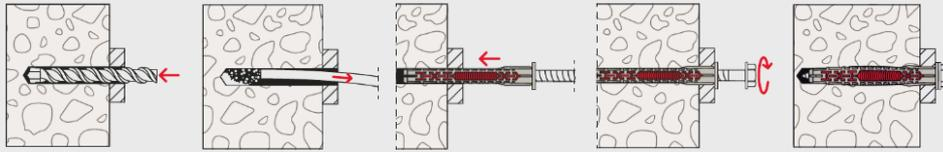
Dans les maçonneries creuses et parpaings\* :
