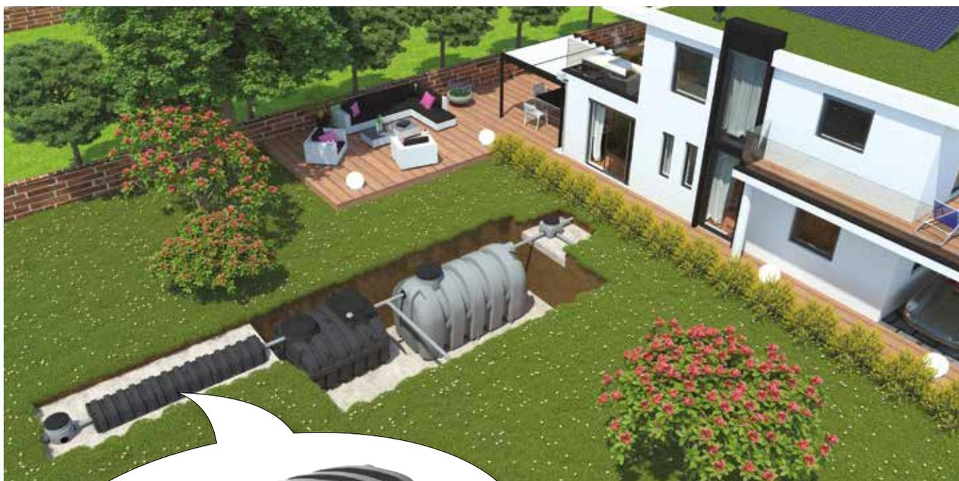
Le tunnel d'infiltration permet la distribution et l'infiltration des eaux traitées. Il s'installe en aval d'une microstation, d'un filtre compact ou d'un filtre à sable drainé.
