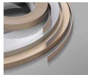
Les chants thermoplastiques ABS EGGER apportent une solution en termes de résistance aux chocs et de design pour le recouvrement des chants des panneaux. Les chants thermoplastiques EGGER sont fabriqués en qualité ABS et sont teintés dans la masse. La contreface du chant est pourvue d'un primaire universel.
