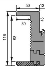
Elargisseur KM1 jusqu'à cloison de 400 mm
