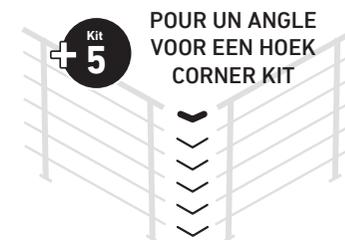
L'ensemble complet mesure 150 cm ou 250 cm de long et peut être raccourci mais aussi prolongé, vous pouvez à tout moment fixer rapidement et facilement des kits supplémentaires. Les lisses sont composées de tiges en acier inoxydable de 16 mm Ø.
