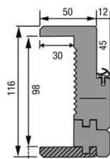
Elargisseur KM1 jusqu'à cloison de 400 mm
