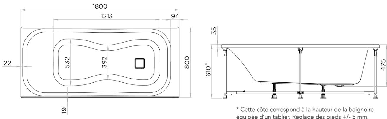
\* Cette côte correspond à la hauteur de la baignoire équipée d'un tablier. Réglage des pieds +/- 5 mm.
