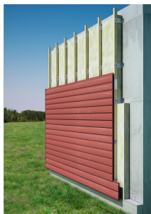
Mise en place d'un pare-pluie
