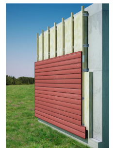
Mise en place d'un pare-pluie
