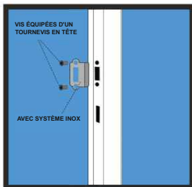
ASSEMBLAGE DE LA TÔLE AVEC SYSTÈME INOX
