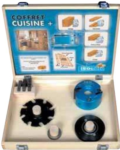
Coffret bois composé des outils de base pour la réalisation de portes de cuisine en contre-profilage avec avancement de 15 mm.
