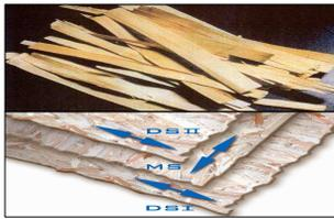
L'OSB est un panneau de bois aggloméré, composé de longues et fines lamelles de bois disposées et orientées en couches perpendiculaires superposées.
