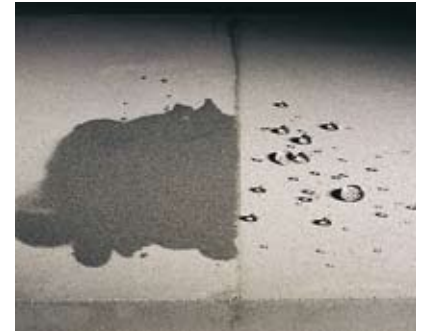
Cette pierre de Florence est, à gauche, non traitée, et, à droite, traitée avec les produits Fila. Sur la partie traitée, on peut remarquer l'effet de gouttes d'eau. Sur l'autre partie, l'eau a été absorbée par la pierre.
