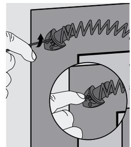
7. Vous pouvez régler la tension du ressort à l'aide de la broche de tension en tournant dans le sens des spires. Bloquez le ressort à la position désirée avec le goujon d'arrêt.
