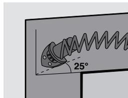
3. Inclinez la patte de fixation de 20 à 25° vers le haut sur le plan horizontal
