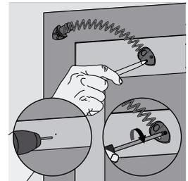
6. Placez la deuxième patte de fixation sur le haut de la porte. Le ressort doit être courbé pour être sous tension. Puis répétez les étapes de 4 à 6.
