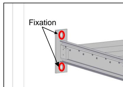
5-3) Enlever le module, puis percer et fixer le brise soleil avec des fixations adaptées à la nature de votre mur. (Visserie non fournie). Trous Ø12 dans les platines
