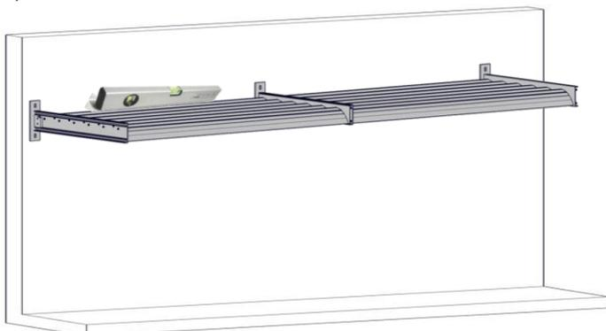
Enlever le module, puis percer et fixer le brise soleil avec des fixations adaptées à la nature de votre mur. (Trous Ø12 dans les platines)
