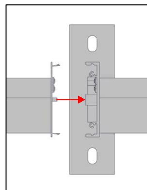
5-5) Puis tracer les trous de fixations en mettant le module de niveau
